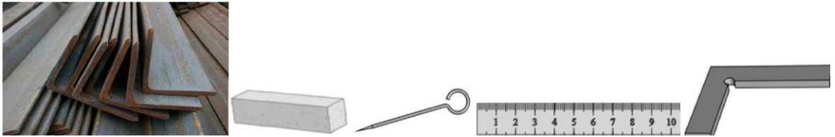
Составьте технологическую последовательность резки уголков на отдельные заготовки с указанием способа резки, оборудования, слесарных и контрольно-измерительных инструментов, охраны труда. Уголок 25\*25\*4 мм, длиной  $L = 2000$  мм, а заготовки должны быть длиной  $L = 200$  мм.
