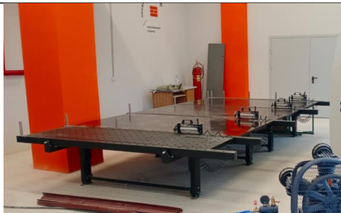
Монтажный стол для сборки каркаса панелей с комплектом инструментов
