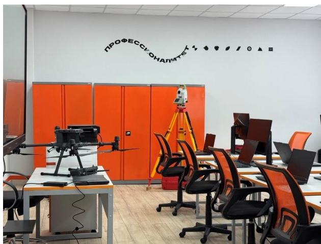
Геодезический квадрокоптер с лазерным сканером с предустановленным полевым программным обеспечением
